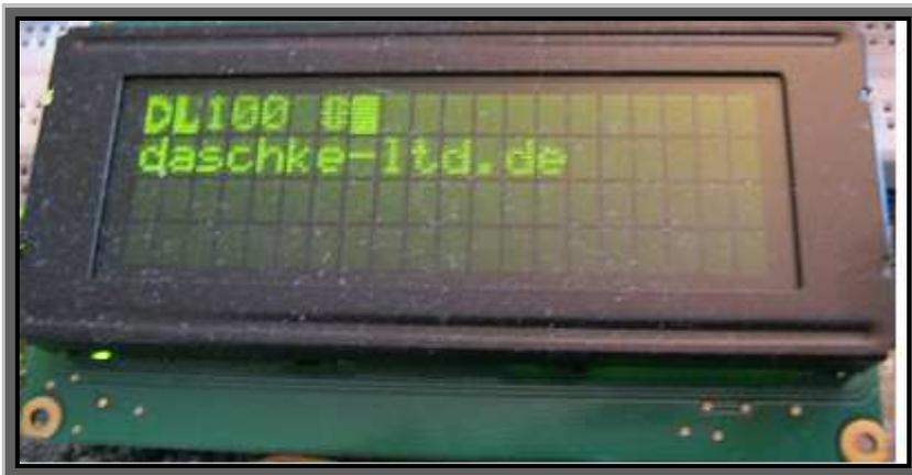
Bei korrekter Beschaltung erscheint das obige Bild auf dem LCD. Jegliche Abweichung davon zeugt von einer falschen Beschaltung des DL100 bzw. des alphanumerischen LCD.
